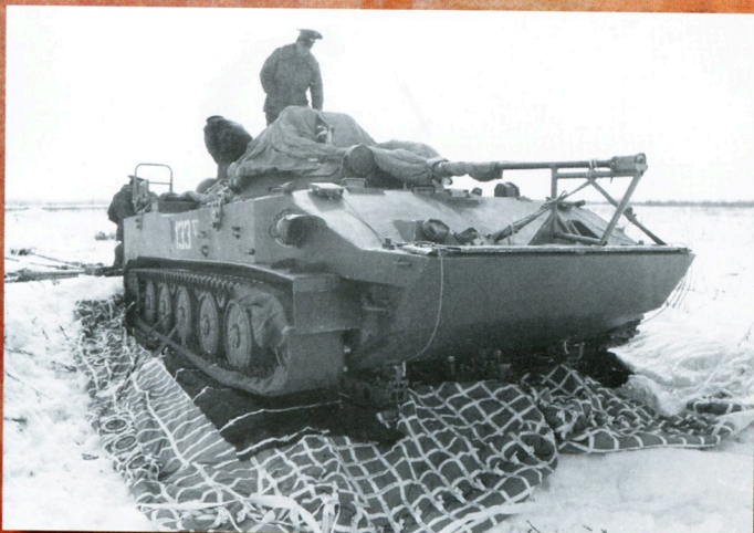
★ БМД-3 после приземления на новой бесплатформенной парашютной системе БПС-950. Псковская область, 6 апреля 1996 года.
