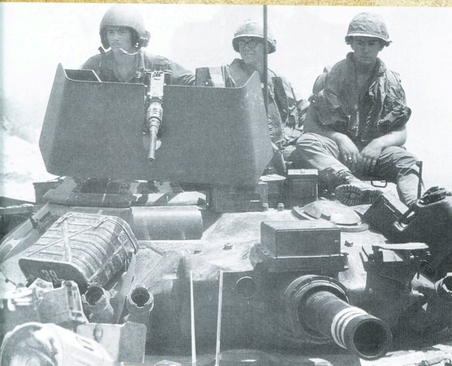
★ М551 «Шеридан» во Вьетнаме. Над стволом орудия – кожух электронного устройства слежения за ИК-трассером ПТУР.
